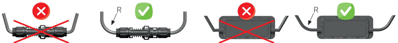
Abb. 5: zulässiger Biegeradius der Solarkabel
